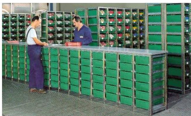
· skrzynki magazynowe na regale z prowadnicami w magazynie detali
